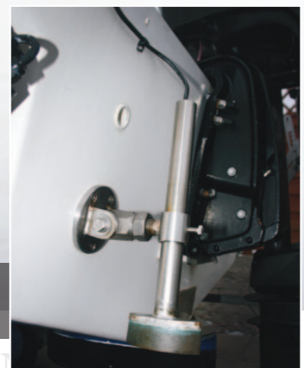
Transducerene kan justeres, så de kan tilpasses varierende vandybder og vinkler.
